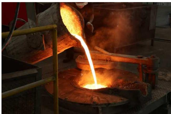
Aquecer as painéis que são utilizadas para vazarem o metal que foi derretido em seus fornos.
