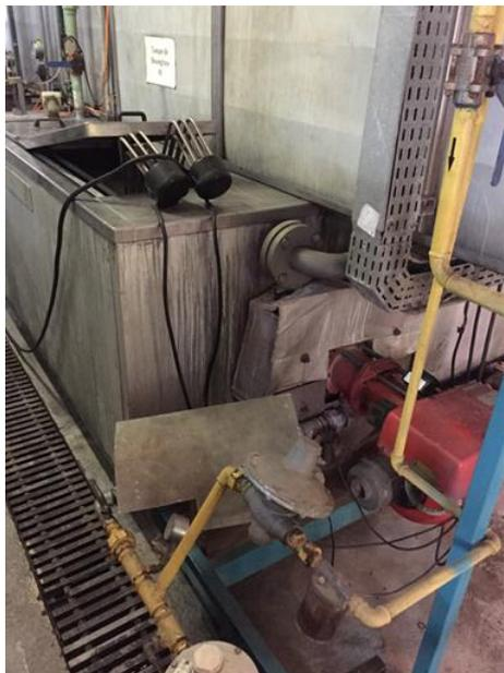
Aquecimento do banho de desengraxe com queimador monobloco necessitando apoio de resistências elétricas para atingir a temperatura de 54°C.
